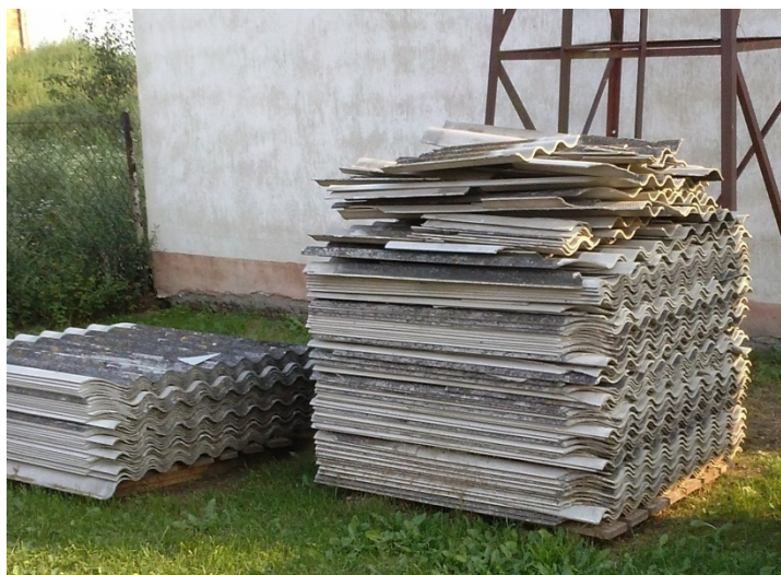
Rys. 2. Płyty azbestowe faliste złożone na paletach ( źródło: materiały własne )
